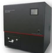
高感度フォトンカウンティング用光電子増倍管を用いた約50フォトン/cm2レベルまで検出可能な最高感度の発光測定装置
